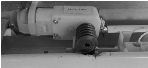
Figura 8. Motor de cierre y apertura de la cortina y su sistema de engranaje.
